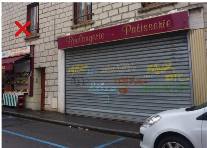
Rideau métallique anti-effraction qui pénalise l'espace urbain en position fermée. Privilégier des systèmes ajourés qui laissent la vitrine visible
