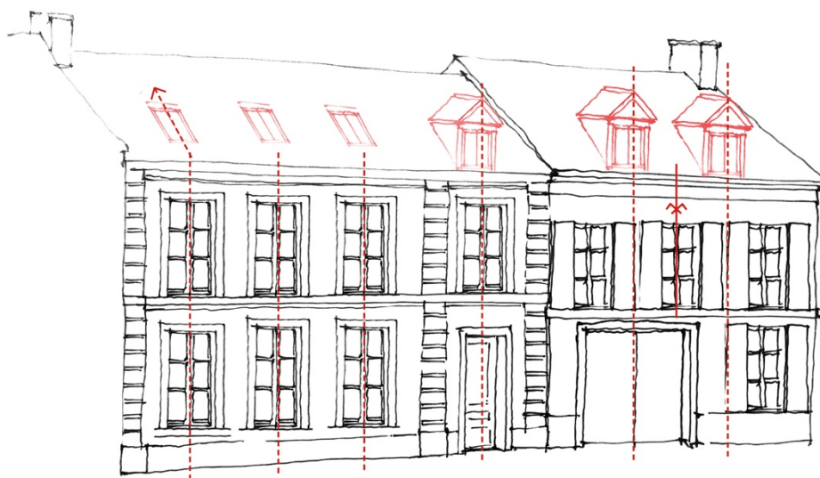
Différents principes de composition des lucarnes ou chassis de toit avec les percements en façade
