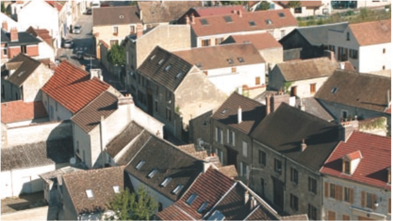
Grande homogénéité des matériaux de toiture dans le centre ancien. Prédominance de la tuile de terre cuite
